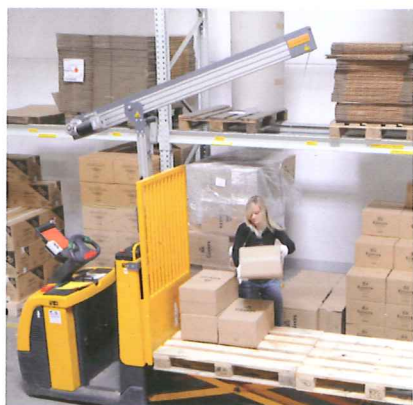
Der ergonomische EcoPick®-Kran entlastet mittels Seilzug und Handschuh-Manschette die Hebe- und Kommissioniervorgänge um bis zu 80 %.
