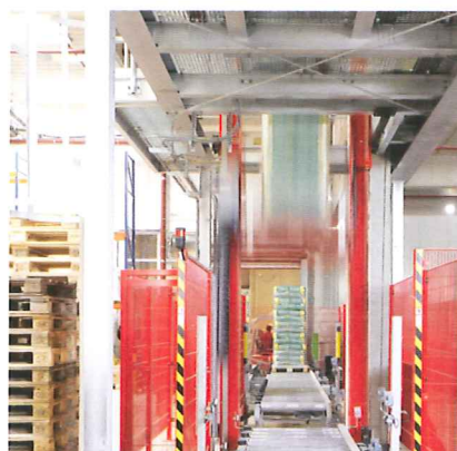
Die automatische Förderstrecke für Vollpaletten umfasst drei Vertikalförderer (Bild), zwei Verschiebewagen und Schwerkraftrollenbahnen.
